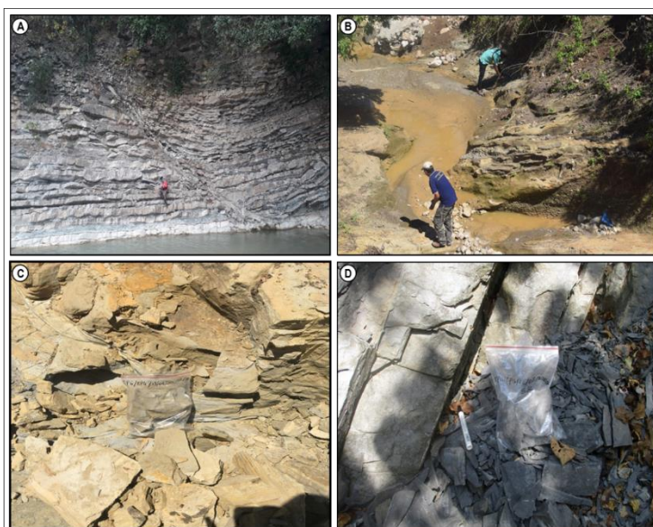
Figura 8 - Atividade de campo no Município de Bobonaro. A,B) Observação direta nos afloramentos; C) Amostra selecionada coletada para análise das rochas do reservatório; D) Amostra coletada para análise de rocha geradora.
